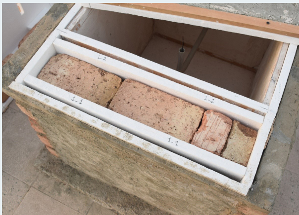
شکل ۵ نمایش عایق‌های جانبی جابجا شونده دیوار اصلی
