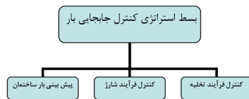
شکل ۳ بخش های اصلی کنترل جابجایی بار
